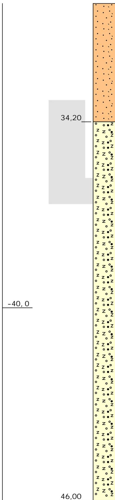
Pleistozän Mittelsand (schwach feinsandig, sehr schwach grobsandig), glazifluviatil, bräunlich, kalkfrei
